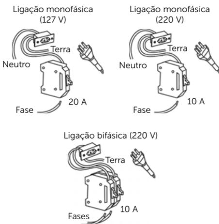
Para modelos 127 V, utilizar uma tomada de 20 A. Para modelos 220V, utilizar uma tomada de 10 A. As tomadas devem estar de acordo com a norma ABNT (Associação Brasileira de Normas Técnicas) NBR 14136.
